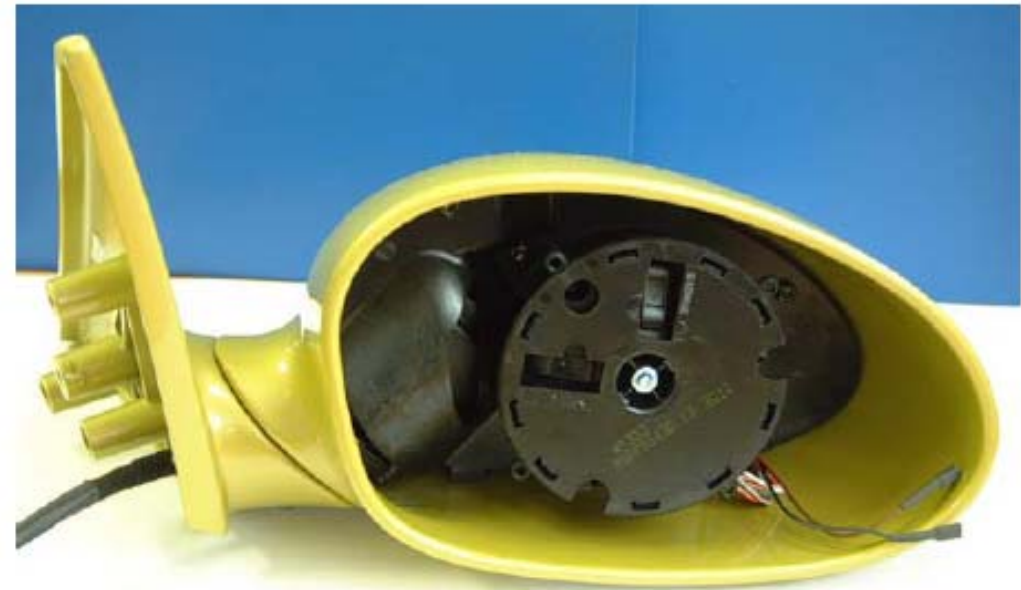
Verstellantrieb für Rückspiegel Hersteller: Magna Auteca
